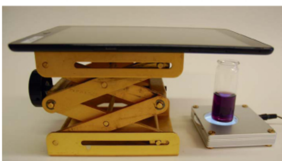
Abb. 3 - Versuchsaufbau zur Photometrie mit einem Tablet
